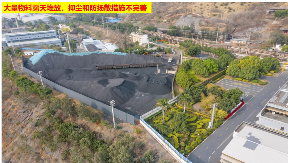
图 22、大量物料露天堆放，抑尘和防扬尘措施不完善
