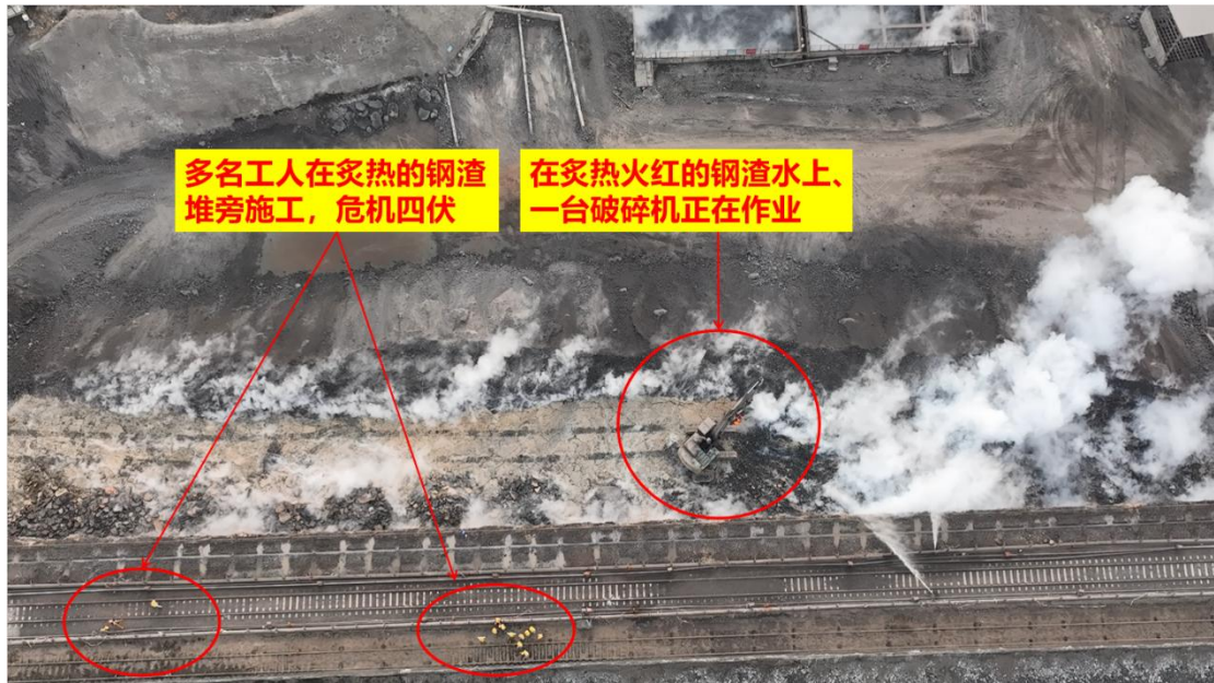
图 8、在炙热火红的钢渣水上、一台破碎机正在作业；多名工人在炙热的钢渣堆旁施工，危机四伏
