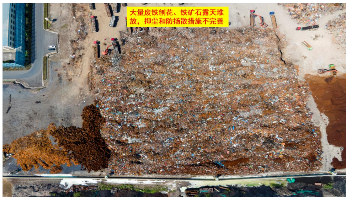
图 19、大量废铁刨花、铁矿石露天堆放，抑尘和防扬尘措施不完善
