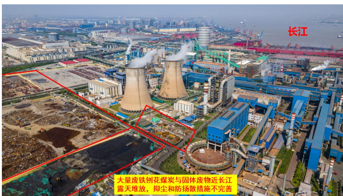
图 18、大量废铁刨花煤炭与固体废物近长江露天堆放，抑尘和防扬尘措施不完善
