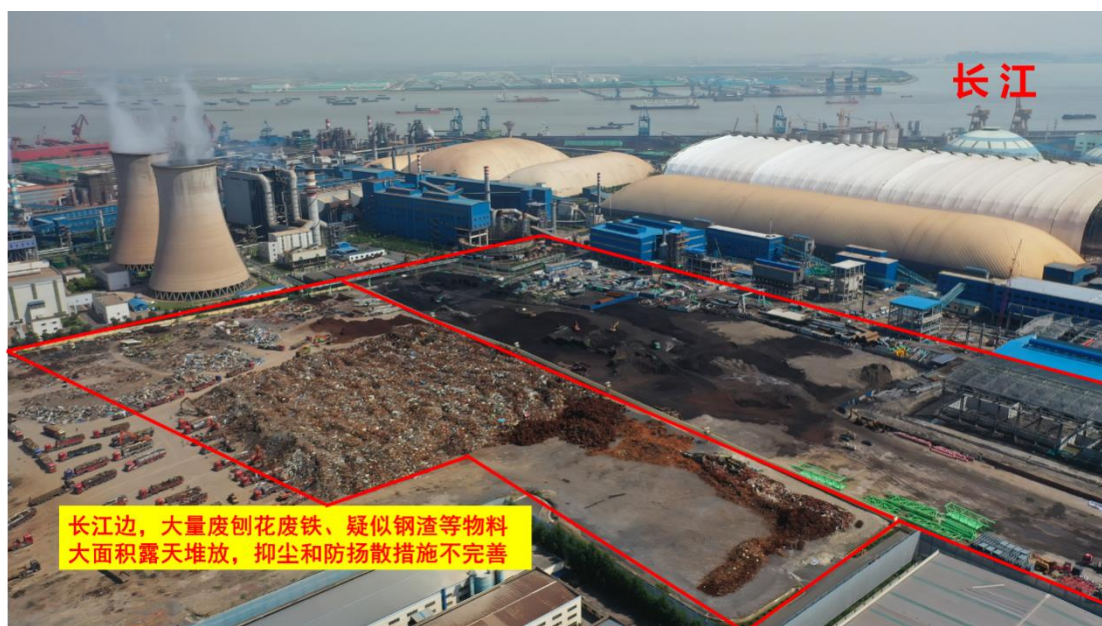
图 40、长江边，大量废刨花废铁、疑似钢渣等物料大面积露天堆放，抑尘和防扬尘措施不完善
