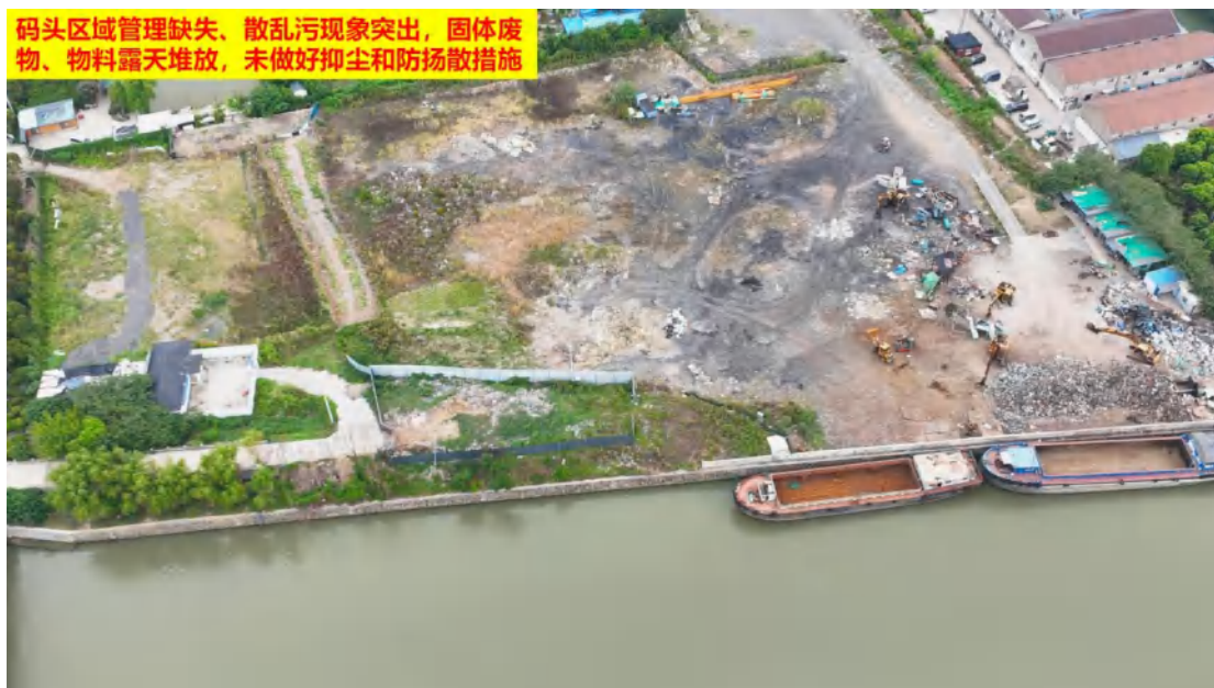
图 5、码头区域管理缺失、散乱污现象突出，固体废物、物料露天堆放，未做好抑尘和防扬尘措施
