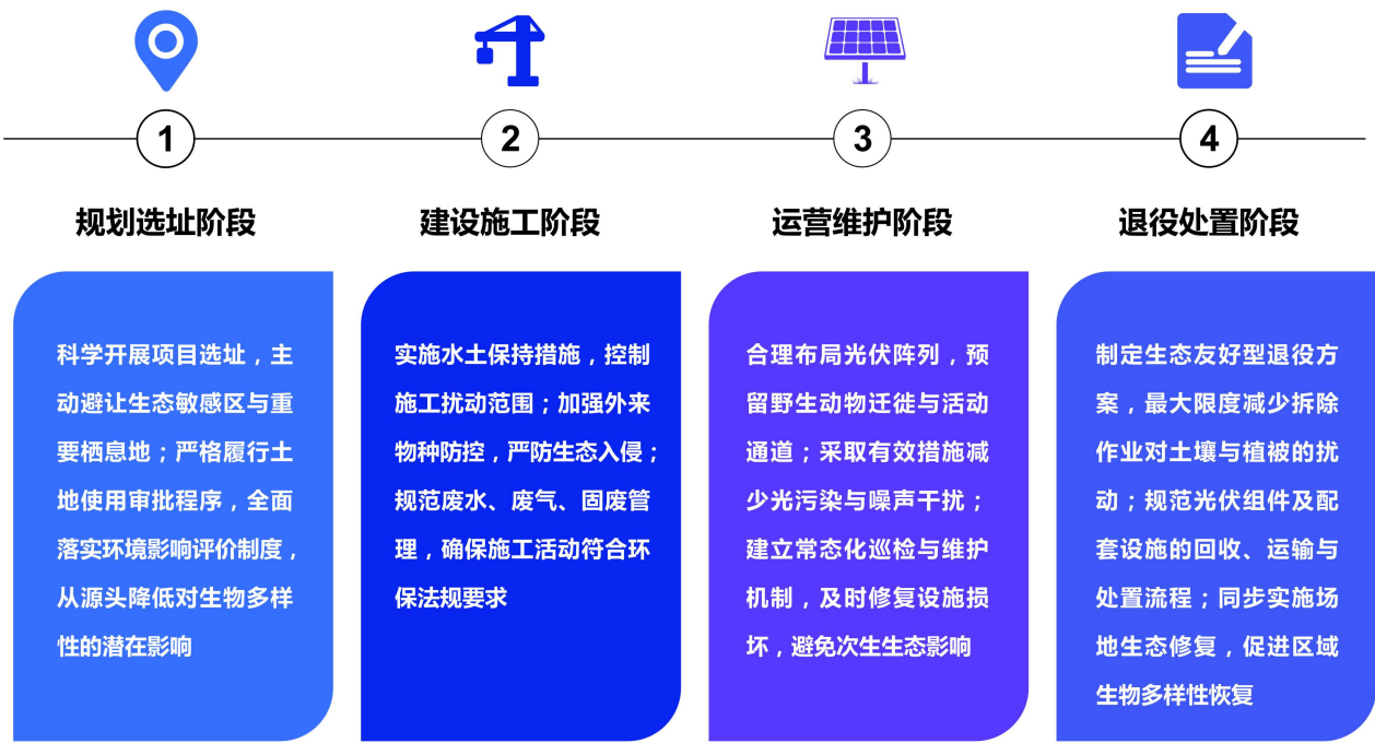
图14 光伏电站生物多样性影响全生命周期示意图
