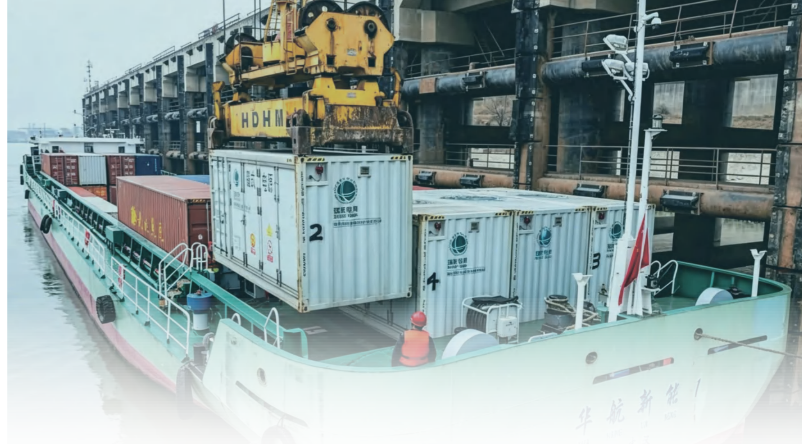
图4、“华航新能1”纯电池集装箱船（图片来源于长江新区公众号） [17]
